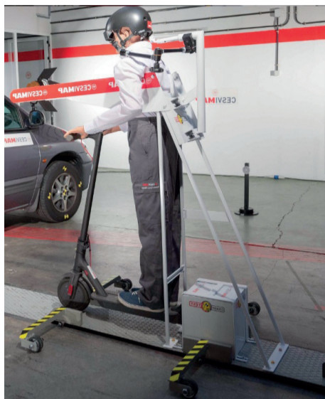
Figura 4. Plataforma, dummy y VMP antes de realizar un Crash-test
