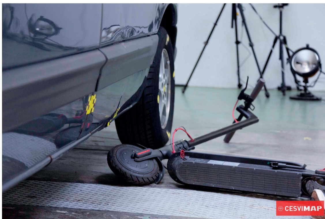
Figura 11. Posición final del VMP después del Crash-test
