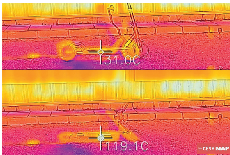
Figura 22. Temperatura de los diferentes elementos que rodean la batería
